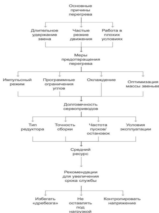
10 Сурет - Қызып кетуді басқару және сервожетектің қызмет ету мерзімін ұзарту
